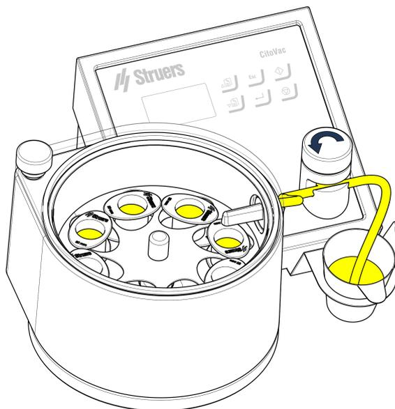
4. 慢慢打开真空阀，直至浸渍材料以合适的流量进入镶样杯。
