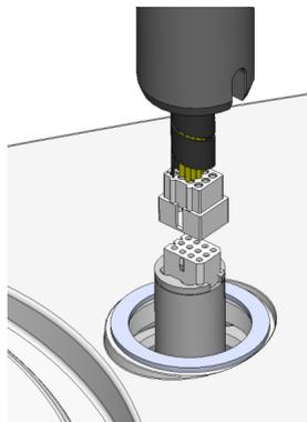
4. 将柱上的黑色 V 形环向下滑直到盖住连接孔。
