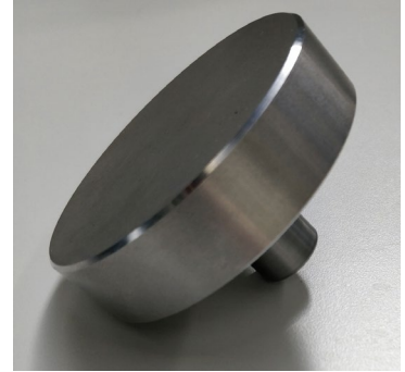
适用于平整样品的平面铁砧。
