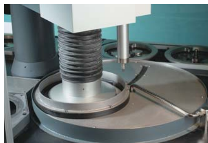
5. Nach dem Schleifen wird der Probenhalter zur Reinigungsstation befördert
