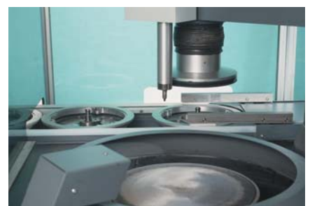
7. Une fois préparé, le porte-échantillons est guidé vers la bande de transport où le métallographe va le récupérer pour procéder à l'examen microscopique
