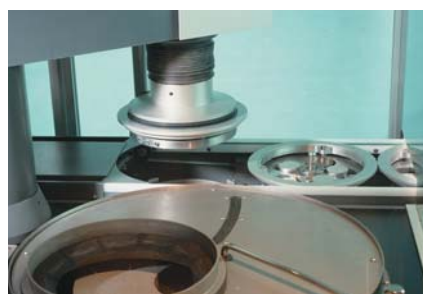
3. Die Probenhalter werden mit einer speziellen Vorrichtung vom Transportband gehoben
