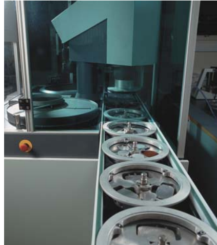
1. Sechs Probenhalter liegen im Transportband, das zu MAPS führt, bereit
