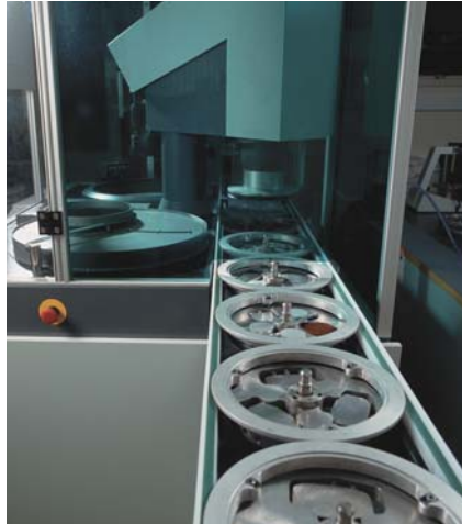
1. Six porte-échantillons sont en file d'attente dans la bande de transport qui va les mener dans MAPS
