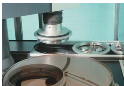
3. Les porte-échantillons sont soulevés de la bande de transport grâce à un dispositif de saisie spécial
