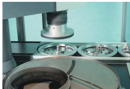
2. Über ein Transportband werden Probenhalter an die erste Präparationsstation (Planschleifen) befördert
