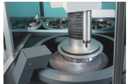
6. Nach dem Feinschleifen wird der Probenhalter zur Polierstation weiterbewegt
