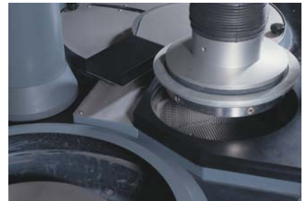
5. Une fois le prépolissage accompli, le porte-échantillons est transporté dans le compartiment de nettoyage
