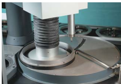
4. Maintenant le prépolissage est en cours. Les porte-échantillons suivants sont prêts à être saisis
