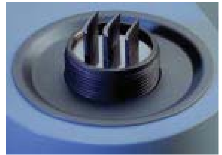
L'utilisation d'une pompe électro-hydraulique garantit un mouvement facile du piston. Même les échantillons très minces peuvent être placés et rester en bonne position quand le piston est soulevé ou abaissé
