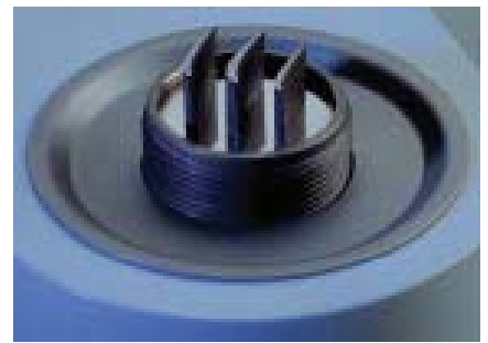
Die elektro-hydraulische Pumpe sorgt für gleichmässigen Lauf des Stempels. Selbst sehr dünne Proben können aufgestellt werden und bleiben auch bei Auf- und Abwärtsbewegung des Stempels stehen.
