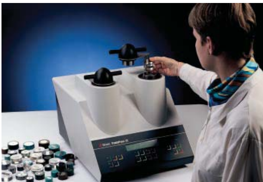
ProntoPress-20 mit den beiden Zylinderen ist unentbehrlich, wenn große Probenreihen oder Proben in verschiedenen Durchmesser eingebettet werden sollen
