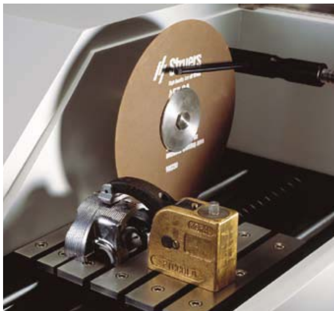
Das vertikale Spannsystem von Struers auf dem beweglichen Trenntisch von Secotom-10
