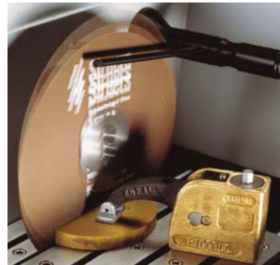
Réglage en hauteur de la meule de tronçonnage - l'un des avantages majeurs de Secotom-10
