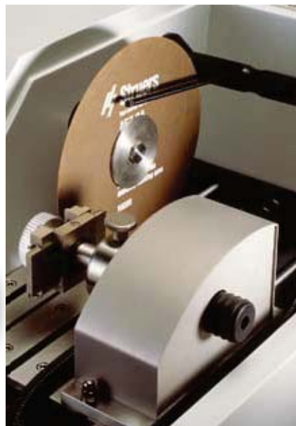
Der Ständer zur manuellen Positionierung mit einem Accutom Probenhalter
