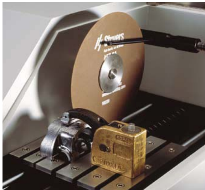
Dispositif de bridage vertical de Struers sur la table de tronçonnage amovible de Secotom-10
