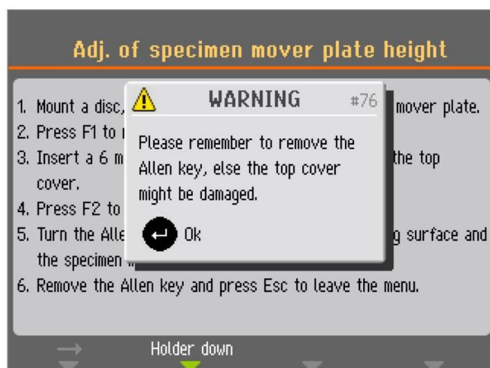
6. Ne pas oublier de retirer la clé hexagonale avant d'utiliser la machine.
