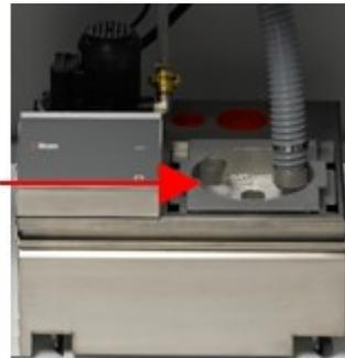
1. Connecter le tuyau d'écoulement d'eau au tube d'écoulement d'eau. Utiliser un collier de serrage pour maintenir le tuyau.
