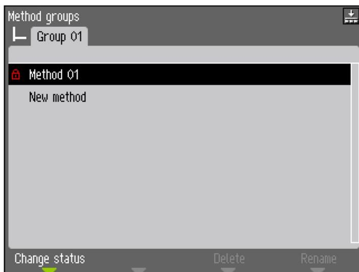
Le symbole de verrouillage devant le nom de la méthode a maintenant changé de statut et indique la méthode verrouillée. Cette méthode peut toujours être modifiée, mais lors de l'enregistrement des modifications, il est uniquement possible de sélectionner **Save method as** (Sauvegarder méthode sous).
