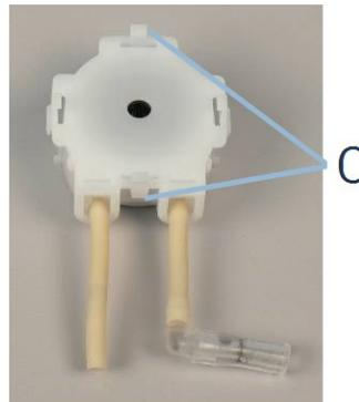
4. Presser les deux languettes sur la pompe (C) et retirer le couvercle du bas.
