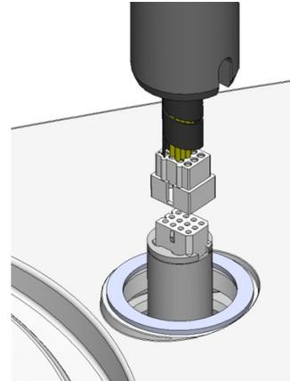
3. Faire glisser la bague en V noire vers le bas, le long de la colonne jusqu'à ce qu'elle couvre l'orifice du support.
