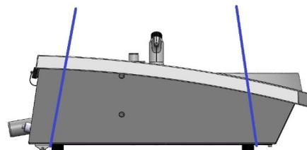
2. Soulever l'avant de la machine et la déplacer avec précaution sur le meuble à l'aide des roulettes de la partie arrière de la machine.
