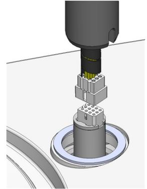
4. Faire glisser la bague en V noire vers le bas, le long de la colonne jusqu'à ce qu'elle couvre l'orifice du support.
