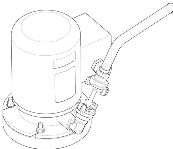
4. Connecter l'accouplement rapide de l'autre côté du tuyau d'arrivée directement à l'écoulement de la pompe de l'unité de recyclage.
