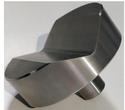
Enclume de type V pour les échantillons cylindriques (option).
