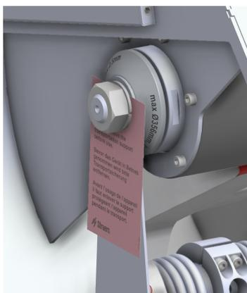
11. Remettre l'écrou M20 en place.
