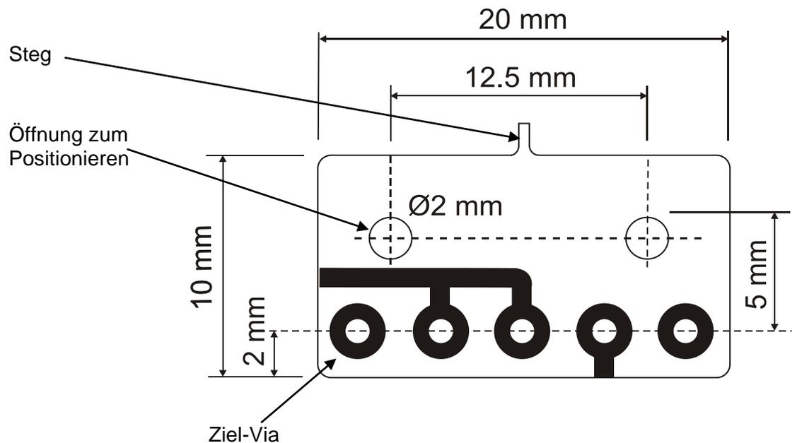
Die mit dem ViaSampler ausgefrästen Coupons weisen einen kleinen Verbindungssteg auf. Dieser Steg erleichtert die Orientierung des Coupons beim Einführen der Positionierstifte und beim Ausrichten der Form. Der Steg liegt bezüglich der Ziel-Vias auf der entgegengesetzten Seite, d.h. in der obigen Zeichnung am Oberrand.
