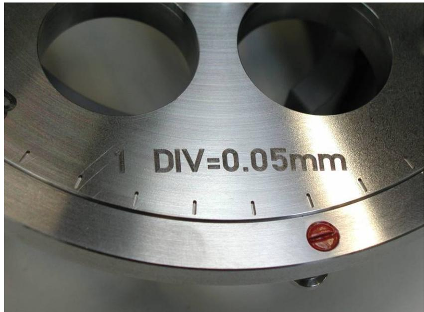
Eine Drehbewegung des inneren Rings am ViaHolder verschiebt die Einbettungen vertikal und relativ zur Oberfläche der Diamantstopps. Folgende Werte entsprechen der Vertikalbewegung der jeweiligen Drehbewegung.
