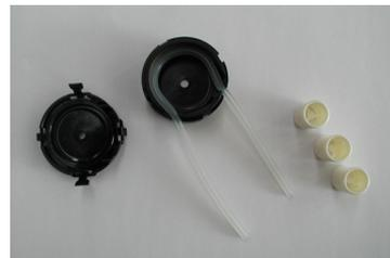
5. Setzen Sie die 3 Rollen wieder in das Pumpengehäuse ein.
