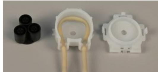
5. Ziehen Sie den Novopren-Schlauch ab.
