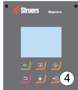
4. Taste Spindelverriegelung
