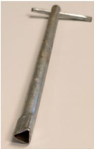
Die Schutzvorrichtungen des Arbeitsbereichs können nur dann geöffnet werden, wenn die Maschine an die Stromversorgung angeschlossen ist und der Hauptschalter eingeschaltet ist. Zum Öffnen der Schutzvorrichtungen ohne Netzanschluss wird ein Dreikantschlüssel verwendet, mit dem das Sicherheitsschloss mechanisch entriegelt wird.
