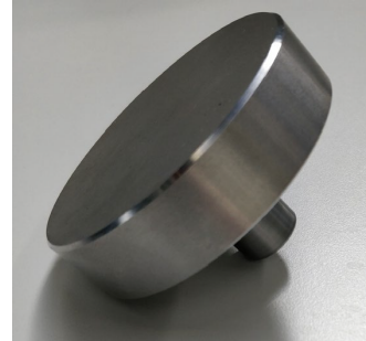
Flacher Prüftisch für gleichmäßige Proben.
