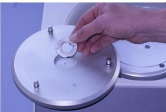
Das LaboPol mit einem SystemAbele-Drehteller kann so modifiziert werden, dass Schleifen und Polieren wie auf einem Standard-LaboPol erfolgen kann.
