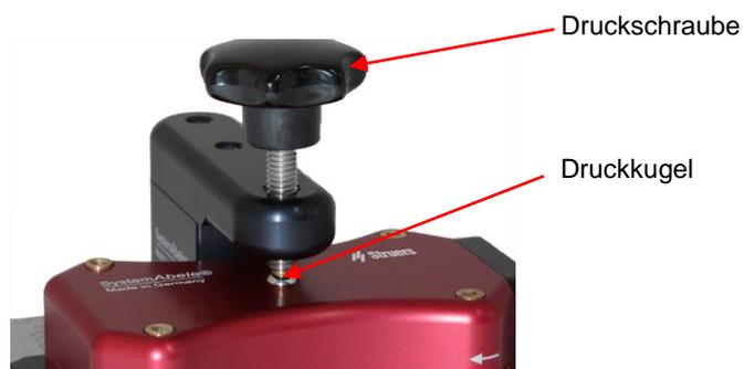
Die Dünnschliffmaus wird passgenau in der Einstellvorrichtung festgehalten, so dass die Positionierung leicht vorgenommen werden kann.
