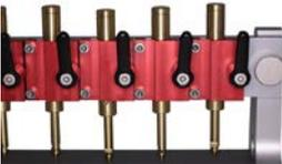
**Tipp:** Falls zum Drehen des Klemmhebels nicht genügend Platz ist, ziehen Sie den schwarzen Griff und drehen ihn zum Lösen nach rechts oder links. Im Idealfall sollten alle Klemmhebel nach oben zeigen.
