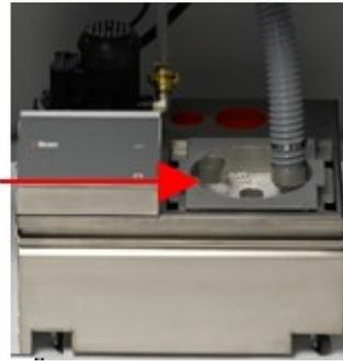
1. Collegare il tubo di uscita dell'acqua al tubo in uscita. Utilizzare una fascetta stringitubo per fissare il tubo.
