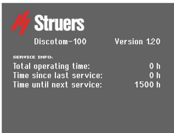
Dopo 1.000 ore di funzionamento (o un determinato numero di mesi) un messaggio a comparsa ricorda che è necessario programmare un intervento di manutenzione. Superate le 1.500 ore di utilizzo, il messaggio a comparsa cambierà per avvisare l'utente che il termine massimo per l'intervento di assistenza è scaduto. Contattare l'Assistenza Struers.
