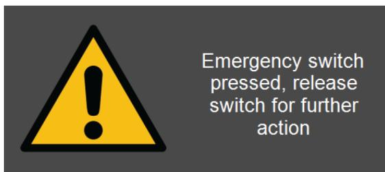
起動中に緊急停止ボタンが作動すると、エラーメッセージが表示されます。
