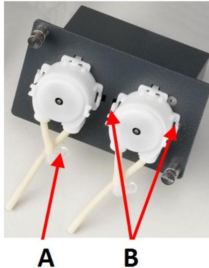
3. Pulse las dos pestañas que hay en la base de la bomba (B) y retire la bomba del eje.
