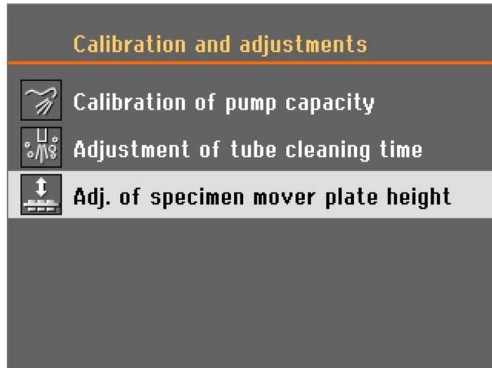
3. Seleccione **Adj. of specimen mover plate height** (Ajuste de la altura de la placa porta muestras).
