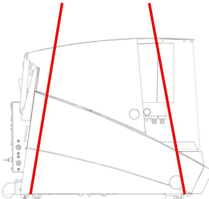
1. Coloque las dos eslingas debajo de la máquina en la parte externa de los pies.
