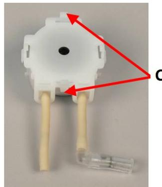
4. Pulse las dos pestañas de la bomba (C) y retire la cubierta inferior.
