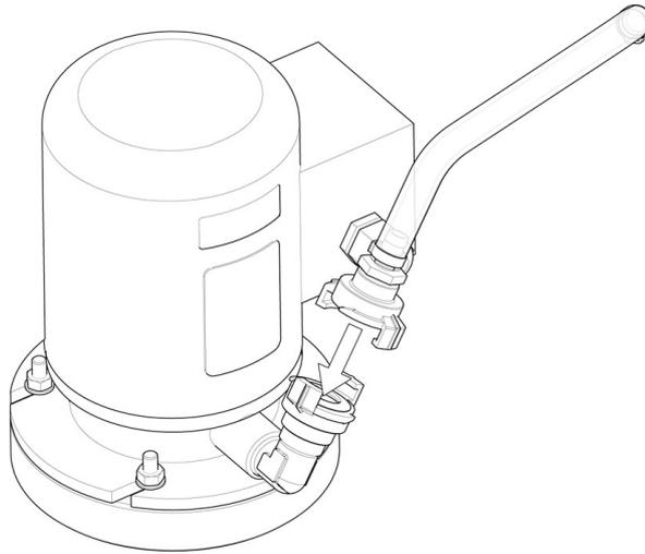
4. Conecte el acoplamiento rápido que hay en el otro extremo de la manguera de entrada directamente a la salida de la bomba de la unidad de refrigeración.
