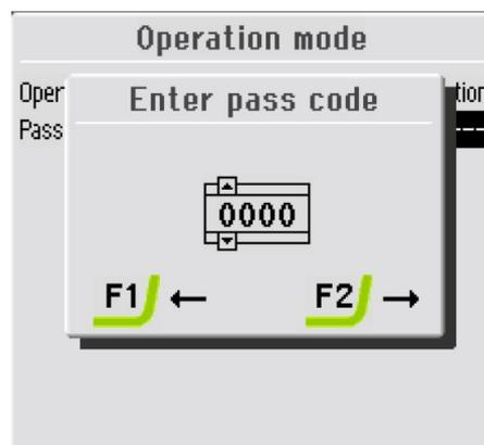
5. Utilice las teclas F1 y F2 para moverse de izquierda a derecha, y el mando para cambiar los dígitos.
