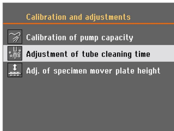
3. Seleccione **Adjustment of tube cleaning time** (Ajuste del tiempo de limpieza de los tubos).
