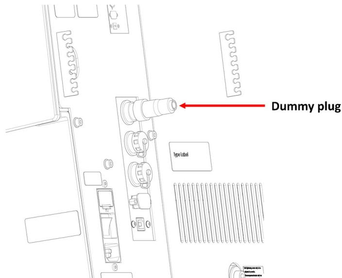
Es necesario colocar un enchufe ciego para que la máquina pueda funcionar sin una cubierta instalada.
