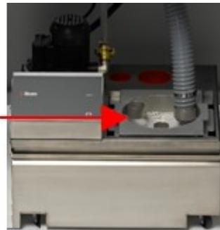
1. Monte la manguera de salida de agua en el tubo de salida de agua. Utilice una abrazadera para sujetar la manguera.
