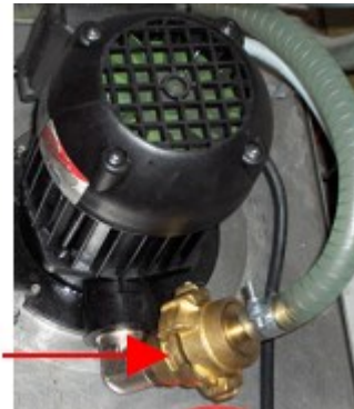
A Salida de la bomba
