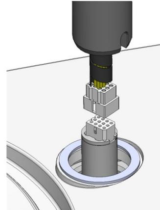
3. Deslice el anillo V negro hacia abajo por la columna hasta que cubra el agujero de conexión.
