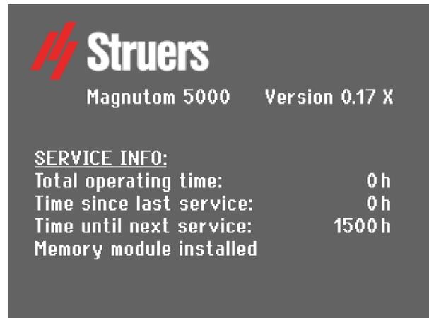
Adicionalmente, se proporciona alguna información sobre el mantenimiento, el tiempo total de funcionamiento y el tiempo transcurrido desde el último mantenimiento de la máquina.
