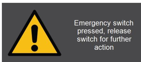
2. El software entra en estado de emergencia donde solo puede controlar los movimientos de la máquina manualmente.
