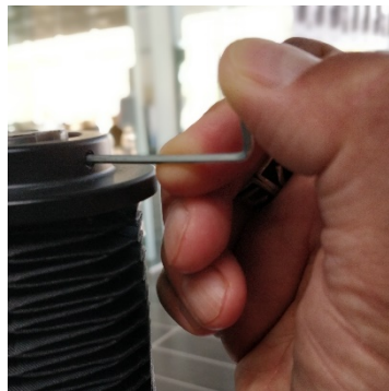
Aflojar el pequeño perno de cabeza hexagonal que mantiene sujeta la cubierta del husillo.
