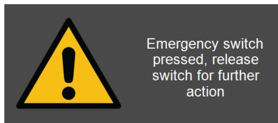
Si se activa la parada de emergencia durante el arranque, se muestra un mensaje de error.
