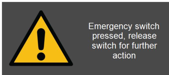
La máquina se detiene y se muestra un mensaje que le indica que desactive la parada de emergencia. Si esto no sucede, contacte con el Struers Service.
