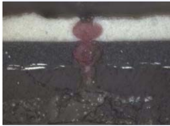
Feuille de métal revêtue, bulles de gaz dans couche de zinc. Diamètre environ 20 µm
