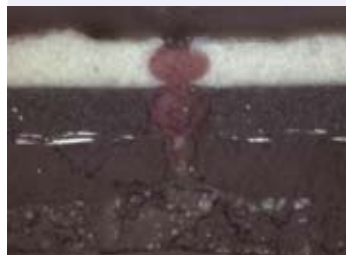
亜鉛コーティングされた 金属シート (φ約20 μmの気泡含有)
