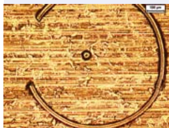
鉄鋼上のPVDによる クロム蒸着層 腐食跡 50倍
